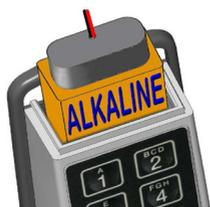
Si vous entendez des signaux consécutifs en ouvrant ceci signifie que votre pile est faible et que la pile doit être remplacée. Utilisez uniquement des piles alcalines 9V neuves de marque comme Duracell, Duracell Industrial, Procell ou Energizer.
