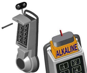
Als het slot bij openen een serie van geluidssignalen laat horen, is de batterij bijna leeg en moet direct vervangen worden. Gebruik hiervoor **alleen nieuwe 9V ALKALINE Duracell, Duracell Industrial, Procell of Energizer Alkaline batterijen.**
